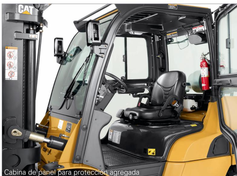
Cabina de panel para protección agregada
